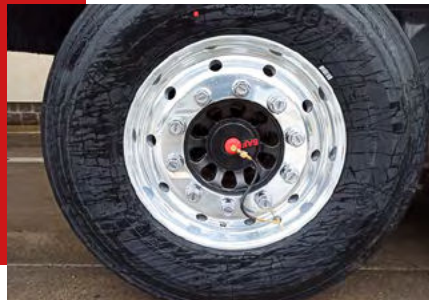
TPRS = Maintien de la pression dans les pneumatiques
