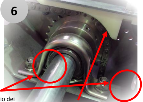
Fissaggio dei pignoni (2x) "catena" (2 viti radiali a 120°)
