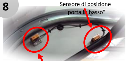
Sensore di posizione "porta in alto"
