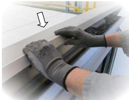
Remettre l'équipement sous tension et réaliser un mouvement complet du **SmartOpen-C** avec les commandes de l'IHM pour contrôler les différents mouvements.
