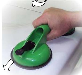
La manipulation doit être effectuée par 2 opérateurs, placés de chaque côté du hard-top.
