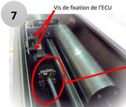
Fixation du module électronique et des connecteurs
