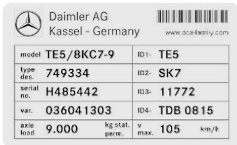
Plaque constructeur de l'essieu Mercedes-Benz. Le logo Mercedes-Benz est visible à gauche. Le texte indique 'Daimler AG Kassel - Germany' et 'www.dca-family.com'. Un code-barres est présent à droite. Le tableau ci-dessous résume les données de la plaque.
