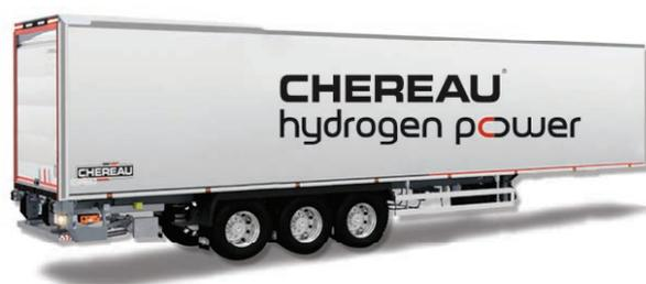
So werden CHEREAU Hydrogen Power Fahrzeuge wie ROAD mit Wasserstofftanks, einer oder mehreren Brennstoffzellen und Pufferbatterien ausgestattet. Die Fahrzeuge werden für mindestens zwei Tage Autonomie auf Langstrecken und einen Tag in der Distribution konzipiert. Das Auffüllen erfolgt in nur 10 Minuten.
