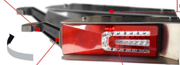
Das Flex-C LED-System wird durch eine Edelstahlverkleidung geschützt, die es wasserdicht und zuverlässig macht.
