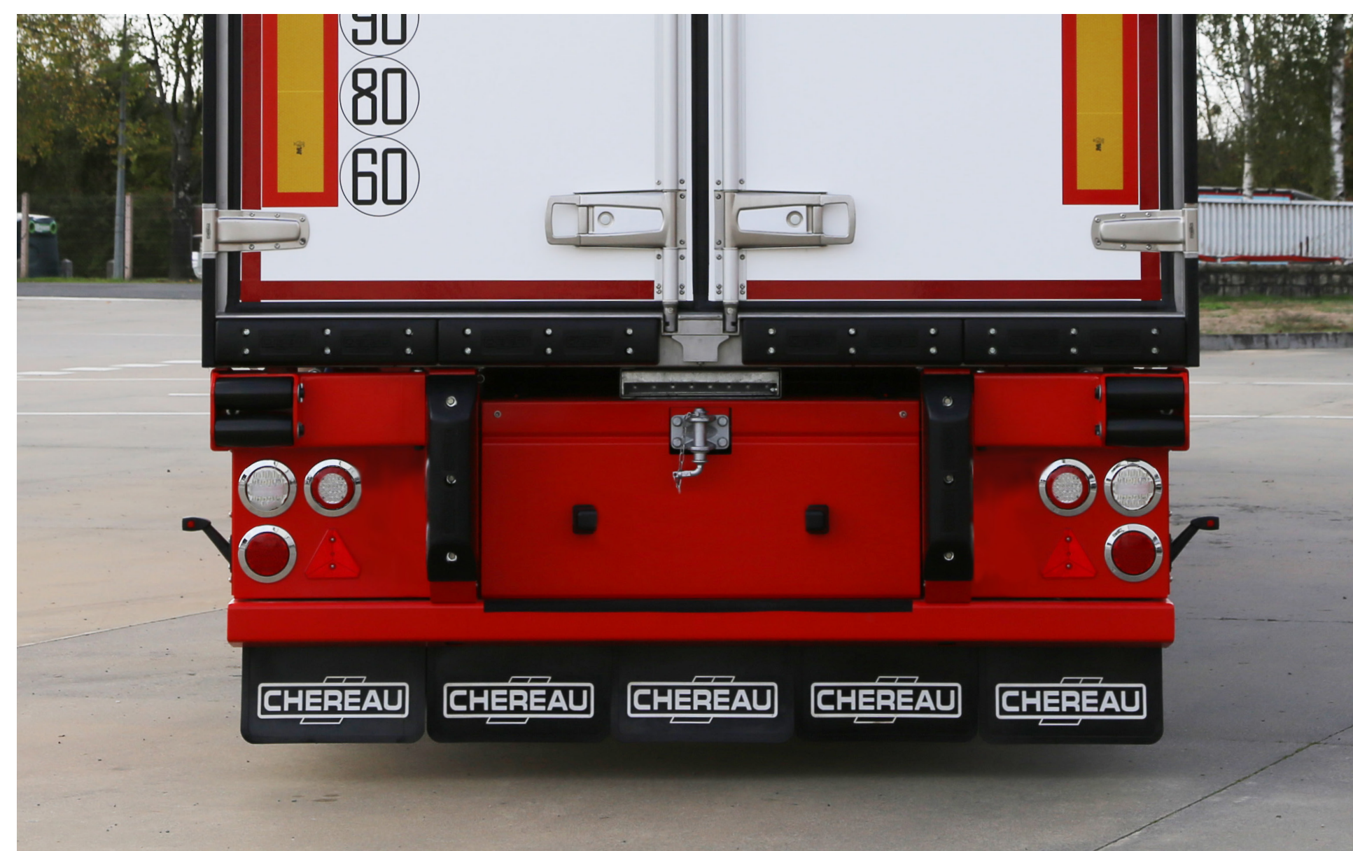
Arrière carré custom avec cinq bavettes CHEREAU / Custom square rear with five CHEREAU mud flaps
